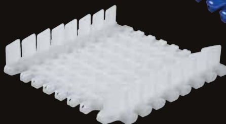
S.101c позитреком. Открытая поворотная лента с низким коллапс-фактором. На приводной стороне ленты находятся выступы, которые центрируют ленту
