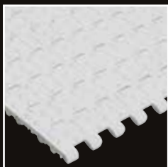
25-830 Лента с закрытой поверхностью со структурой конус H=3мм. Легко очищаемая. Для охлаждения/заморозки и транспортировки продукции под небольшим наклоном.
